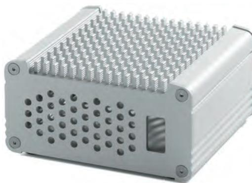
ヒートシンクに垂直方向の溝加工を入れることでピン型フィン形状にすることが可能です。表面積がさらに大きくなり、放熱効果がアップします。
