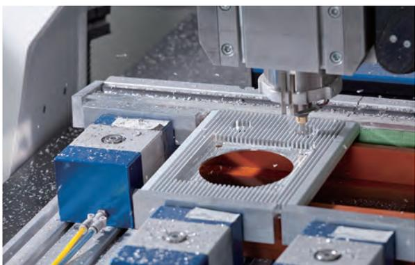
タカチでは高速マシニングセンタにより、ヒートシンクをはじめ、どんな形状のアルミ素材も加工致します。
