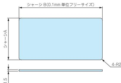
シャーシ寸法 ■ 材質 / 表面処理 : A1050P / 無処理
